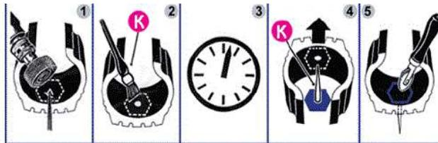
Рис.10.7 Ремонт шины ТРЭКОЛ грибком (с демонтажём)
