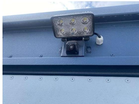
Рис. 20.44 Камера заднего вида
