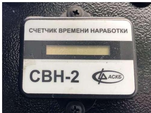
Рис.20.49 Счётчик моточасов
