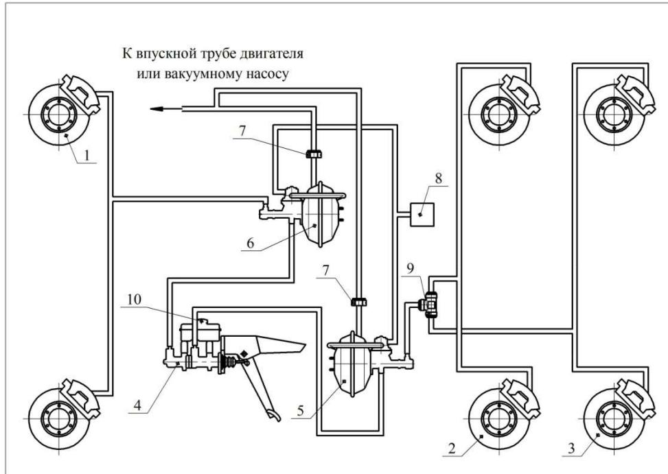
Рис. 6.15 Схема гидропривода тормозов:
