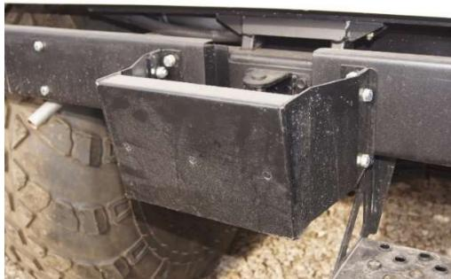
Рис.20.23 Приспособление для установки лодочного мотора
