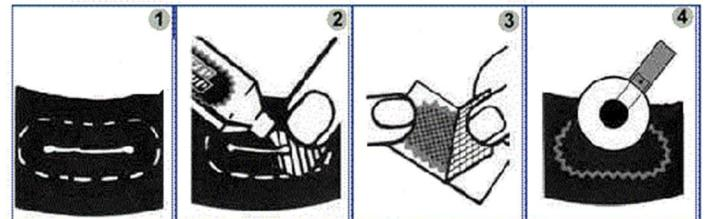
Рис.10.6 Ремонт шины ТРЭКОЛ пластирем (с демонтажем)
