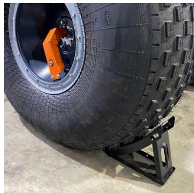
Рис.20.51 Упор противооткатный
