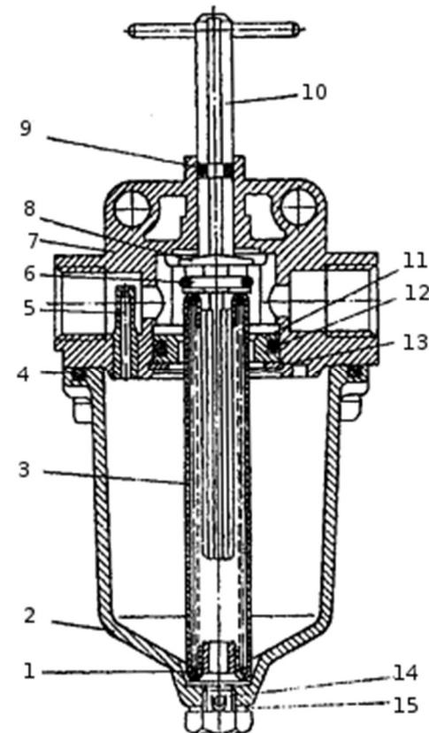
Рис. 20.2 Предохранитель от замерзания
