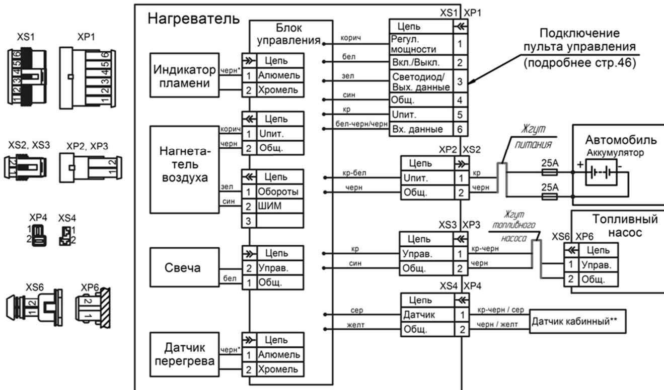
Рис. 20.16 Электрическая схема подключения воздушного отопителя
