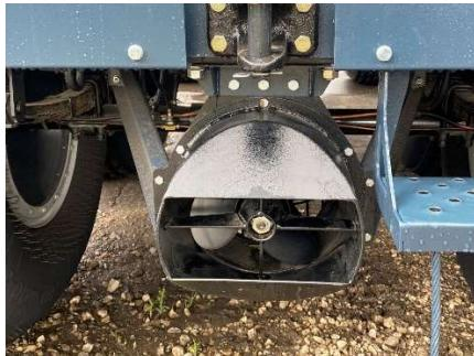
Рис.20.22 Водомётный движитель
