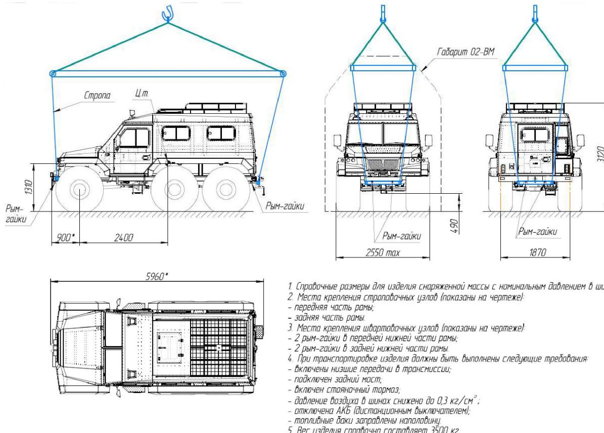
Рис. 15 Схема расположения строповочных и швартовочных узлов ВТС
