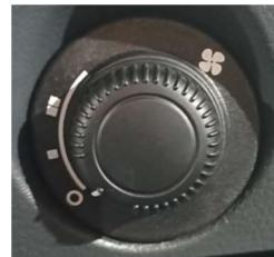
Рис. 5.10 Переключатель вентилятора заднего дополнительного отопителя
