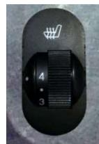
Рис. 5.18 Регулятор управления подогревом сидений
