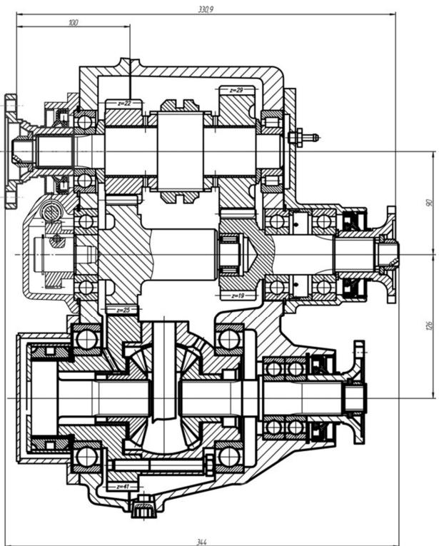
Рис.6.4 Коробка привода заднего ведущего моста с приводом водомётного движителя
