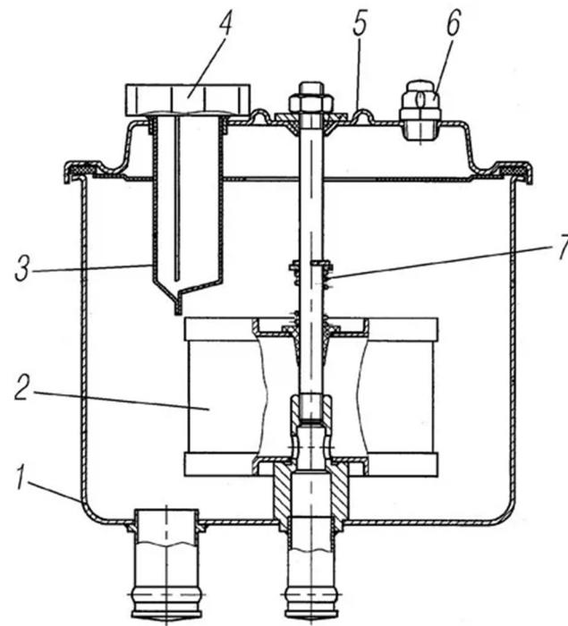
Рис. 6.14 Бачок усилителя рулевого управления:
