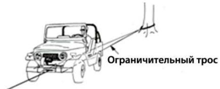
Рис. 20.9 Пример того, как правильно ограничивать автомобиль при транспортировке тяжелых грузов, когда колесных блоков недостаточно. Ограничительный трос или цепь прикрепляется к якорю как можно ниже, проходит под автомобилем и надежно крепится за прочие части установочного комплекта лебедки. Способ крепления к задней раме или балке моста имеет определенный риск. Мощности лебедки достаточно, чтобы сломать или согнуть раму или балку моста
