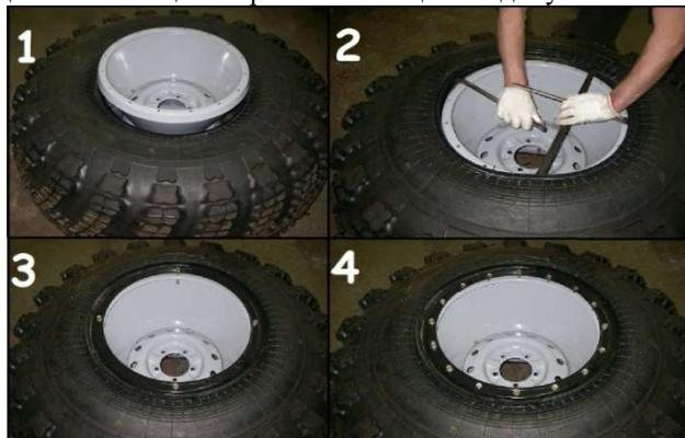
Рис. 10.4 Порядок монтажа шины ТРЭКОЛ
