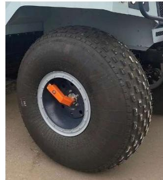
Рис.20.33 Система централизованной подкачки колёс
