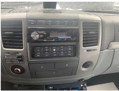
Рис.20.47 Автоматомагнитола 1 DIN, динамики, радиоантенна
