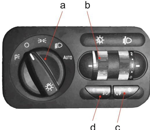
Рис. 5.6 Модуль управления светотехникой (вариант 1)
