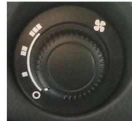
Рис. 5.12 Переключатель вентилятора переднего основного отопителя
