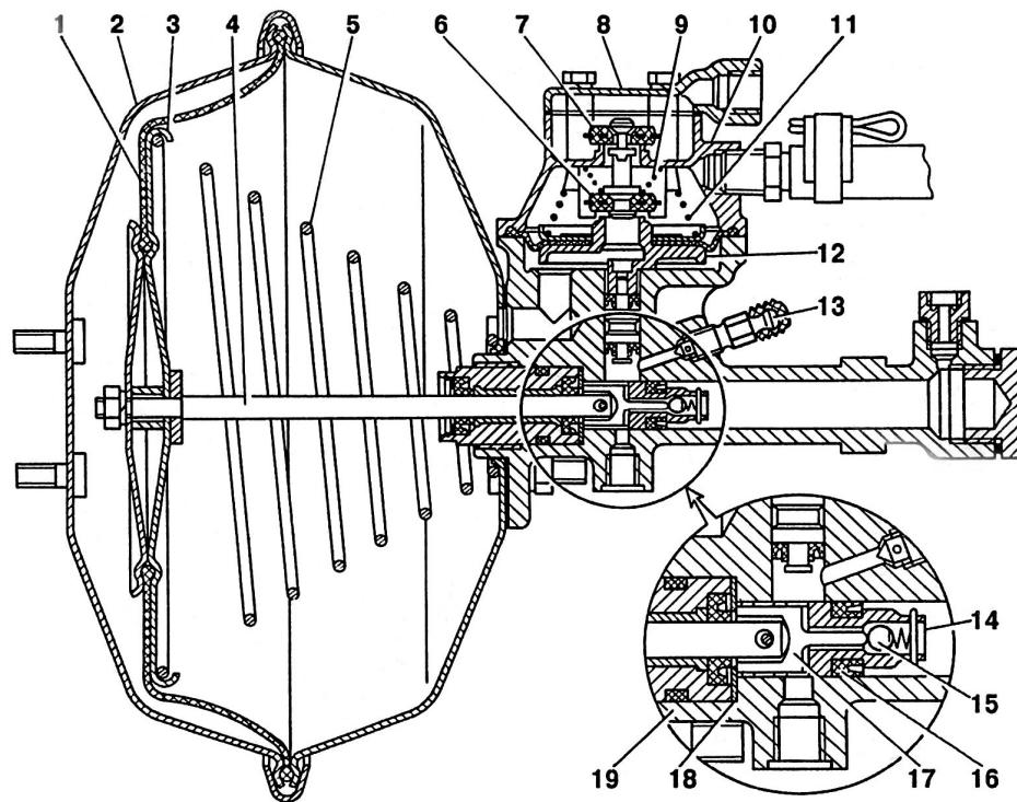
Рис. 6.17 Гидровакуумный усилитель
