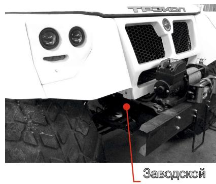
Рис. 4.3 Место обозначения завода номера ВТС
